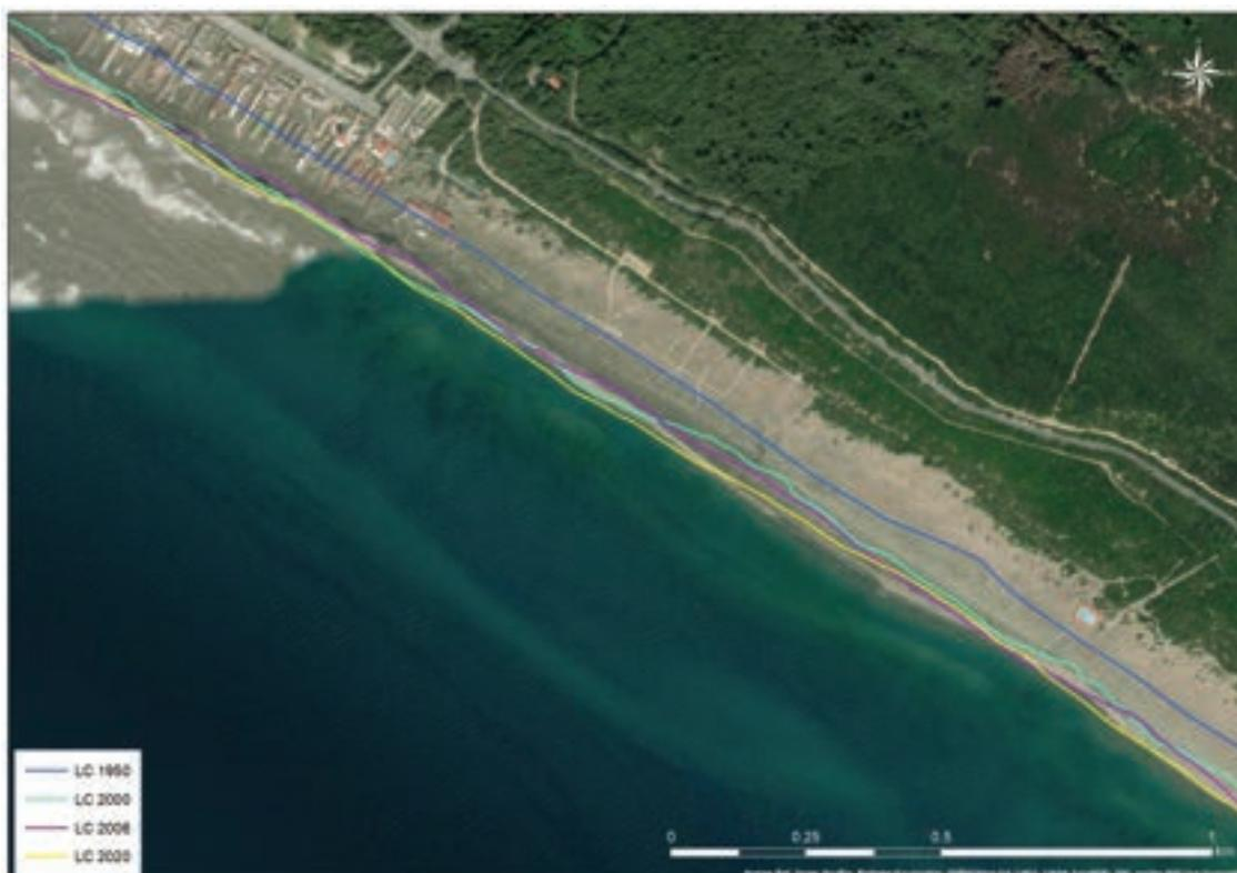
**Figura 3 C.** *Variazione delle linee di riva nell'area di Tor Paterno.*
